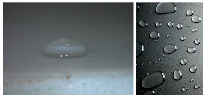
Рис. 4. Капля воды на покрытии из фторуретана. Краевой угол смачивания около 110°
