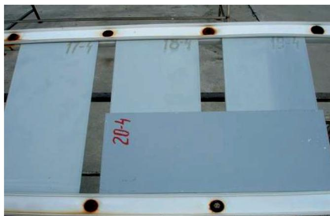
Рис. 8. Внешний вид покрытия на основе фторуретана (20-4) после 12 лет экспозиции в тропических условиях
