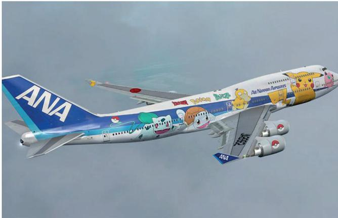
Рис. 1. Boeing 747 японской авиакомпании ANA, окрашенный лакокрасочными материалами на основе фторированных уретанов
