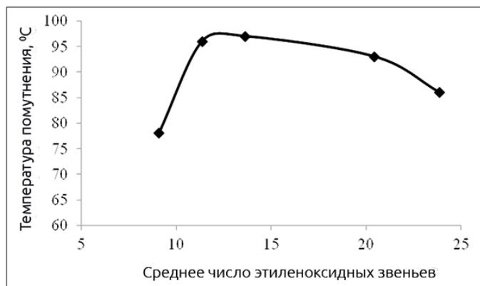
**Рис. 2.** Зависимость температуры помутнения растворов поверхностно-активных веществ от среднего числа этиленоксидных звеньев после нейтрализации
