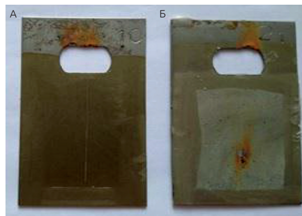
Рис. 5. Внешний вид кадмий-полимерного (А) и полимерного (Б) покрытия после выдержки в дистиллированной воде в течение 2920 ч
