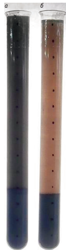
Рис. 3. Результаты 30-дневной седиментации суспензий цинкового порошка в лапроксиде-703 с добавкой (а) и без добавки ГМС (б)
