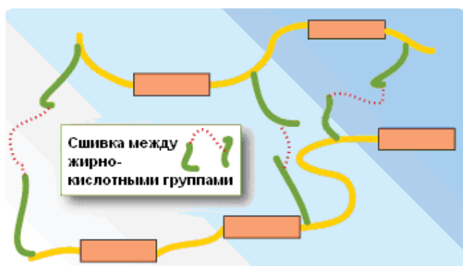
Рис. 3. Гибкое внедрение жирной кислоты в мягкий сегмент
